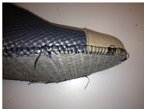
Figura 2 - Calçado costurado na palmilha de montagem (Strobel) Fonte: (Elaborado pelo autor)
